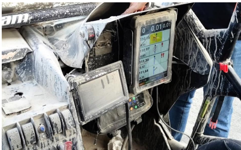
Instalación equipo CapRoad con soporte en el salpicadero con silentblock/tornillos
